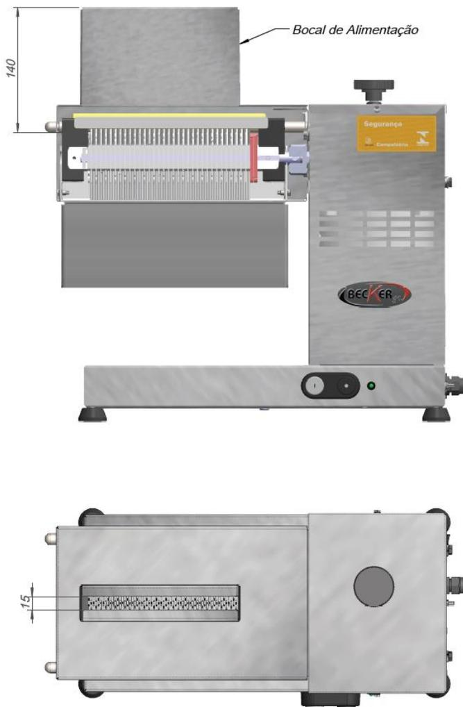
**Fig. 7– O bocal de alimentação deve impedir o acesso dos membros superiores à área dos cilindros dentados – Item Atendido.**
